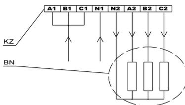
Рис.1б Пример однофазного подключения ТЭНБ-6
