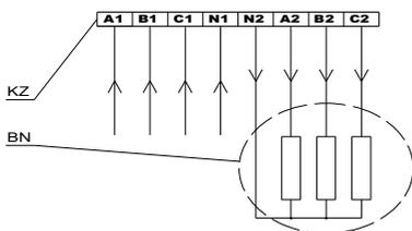
Рис.1а Пример трехфазного подключения ТЭНБ-6 , ТЭНБ-9
