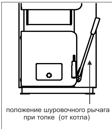
Рис.10 Установка рычага шуровочного механизма
